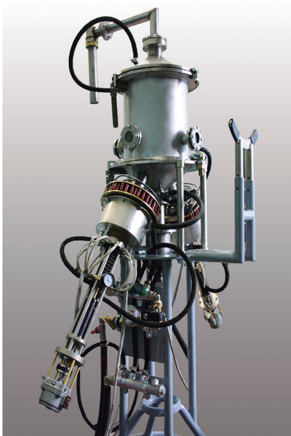
Рис. 12. Фотография установки для синтеза фуллеренов при давлениях гелия 0.1 до 0.4 МПа
